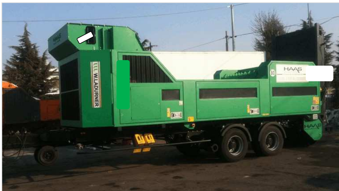
Figura 6 - Trituratore veloce a martelli per rifiuti ligneocellulosici
