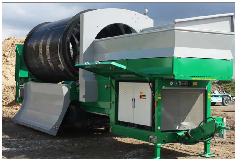
Figura 24 - Immagine di un vaglio a tamburo rotante, con tramoggia di carico.
